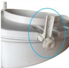
۳. در نهایت درب و حلقه توالت فرنگی را برداشته و مکمل روی لبه سرامیکی توالت فرنگی قرار می دهید و پیچ های طرفین را سفت میکنید. برای استحکام و چسبندگی بیشتر توصیه می شود از چسب سیلیکون یا چسب آکواریوم استفاده کنید بدین صورت که روی لبه سرامیکی توالت فرنگی بصورت پیمایی چسب میزنید و مکمل روی چسب قرار می دهید و بعد از ۶ ساعت چسب خشک شده و مکمل قابل استفاده می باشد.
